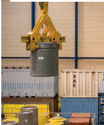
MANUTENTION DE COQUES BÉTON DANS LE BÂTIMENT DE TRAITEMENT DES EFFLUENTS BTE CNPE de Saint Alban, Isère
